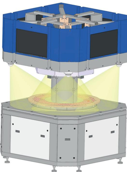
Les caméras dôme sont orientables pour regarder à l'intérieur de la machine, notamment les process critiques, ou bien sur des périphériques.
